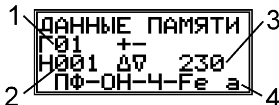
Рисунок 7. Индикатор прибора «Константа ВД1» в режиме просмотра данных в памяти
