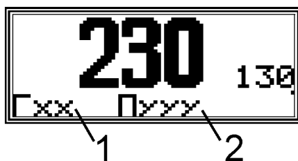
Рисунок 6. Сообщение на индикаторе прибора «Константа ВД1» при проведении записи в память
